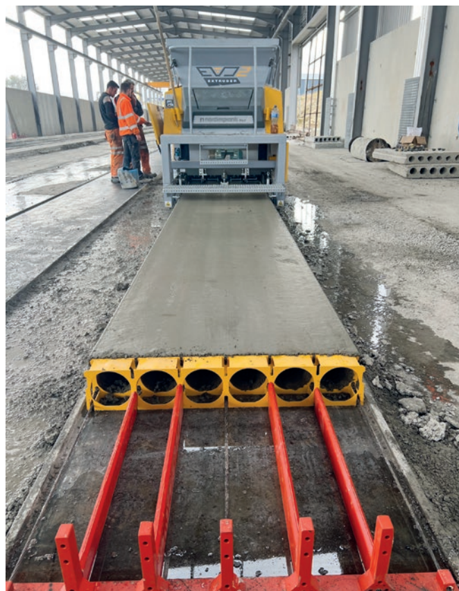
L'extrudeuse EVO2 pendant la phase de coulée
